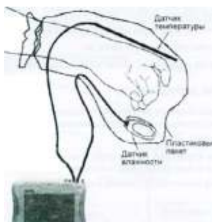
Рис. 17. Схема экспериментальной установки терморегуляции кожи
