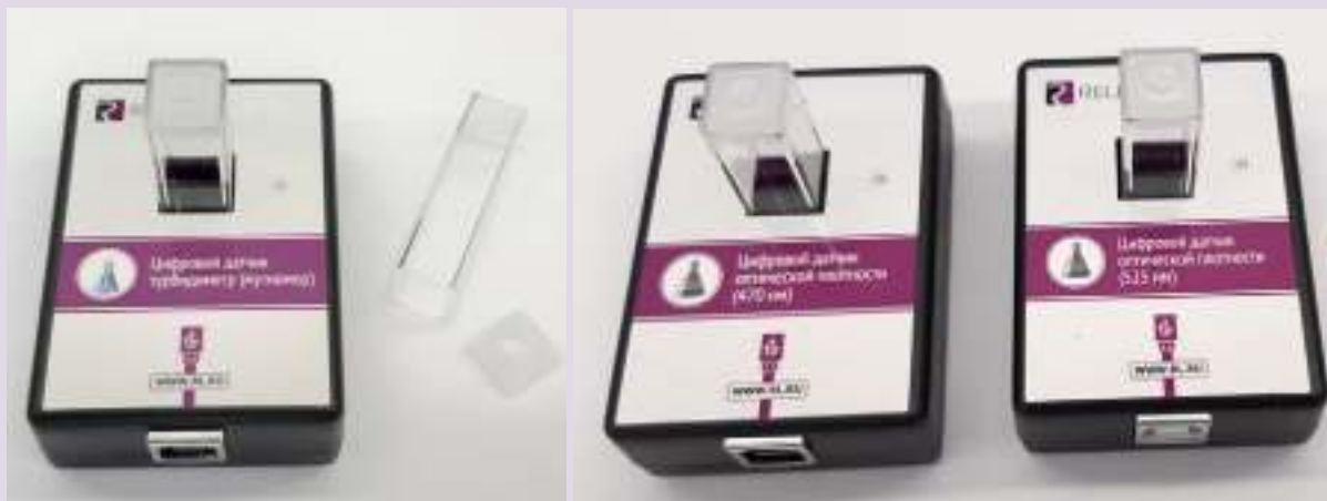
Рис. 8. Датчики мутности (слева), оптической плотности на 465 нм (в центре) и 525 нм (справа)
